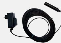
La bomba se para automáticamente cuando el interruptor de nivel se encuentra fuera del agua. Cuando el interruptor vuelve a estar en contacto con el agua y después de un tiempo ajustable de 2 a 15 min., la bomba vuelve a arrancar. El ajuste del tiempo evita los arranques y paradas sucesivas que pueden dañar la bomba.
